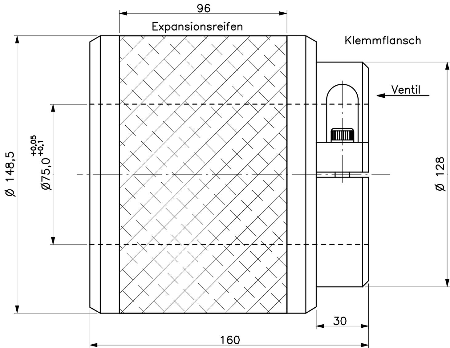
Maximal übertragbares Drehmoment: 615 Nm, bei 6 bar
