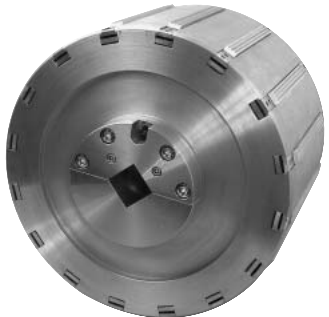
Bild 17: Pneumatikspannkopf für Hülseninnendurchmesser 350 mm, 16 Spannleisten am Umfang
